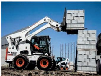
A Zeta traz soluções baratas e diferenciadas para o transporte horizontal em seu canteiro. A minicarregadeira S850 é capaz de descarregar caminhões com pallets acima de 2.000 kg, além de fazer o transporte horizontal de pallets com até 4.000 kg. Outro implemento para as Minicarregadeiras é o Dumper, capaz de transportar até 2m<sup>3</sup> de material. Caso seja necessário a manipulação vertical da carga, também dispomos de manipuladores telescópicos de 7 a 17 metros.
