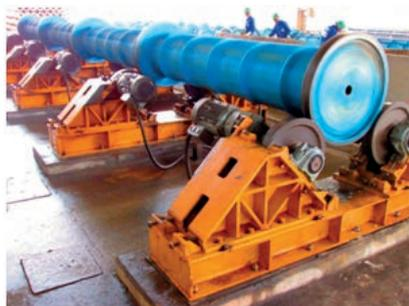
A T&A Pré-Fabricados deu início à produção de estacas de concreto na sua unidade paulista, localizada em Itu (SP). A indústria fabricará estacas protendidas e centrifugadas, sendo estas com diâmetros de 350, 400, 500 e 600 milímetros. As peças estão sendo produzidas em máquinas centrífugas com tecnologia desenvolvida pela própria empresa, que juntas têm capacidade de produzir 25 mil metros lineares de estacas por mês.
