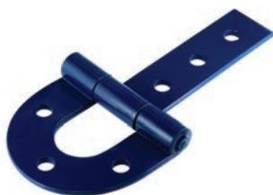
As Dobradiças São Romão oferecem qualidade, vida útil prolongada, além de excelente desempenho. Utilizadas, especialmente, em porteiras e portões de obra, as dobradiças são de fácil instalação e utilização. Produzidas em aço 1020 e pintura epóxi de alta resistência, a linha é composta de sete diferentes tamanhos. Dobradiças São Romão, todas as suas expectativas reunidas em um só produto.
