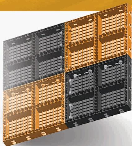
O conceito é substituir a utilização do compensado de madeira por essas peças plásticas na concretagem das lajes. Elas são apoiadas diretamente nos barrotes da mesma maneira que o compensado.
