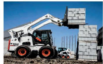
A Zeta traz soluções baratas e diferenciadas para o transporte horizontal em seu canteiro. A minicarregadeira S850 é capaz de descarregar caminhões com pallets acima de 2.000 kg, além de fazer o transporte horizontal de pallets com até 4.000 kg. Outro implemento para as Minicarregadeiras é o Dumper, capaz de transportar até 2m<sup>3</sup> de material.
